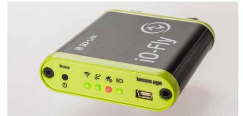
Farbige LEDs geben Auskunft über den Zustand des iO-Fly, den Ladestand des Akkus, die Verbindung zum IO-Link-Device sowie über Existenz und Art einer Drahtlos-Verbindung. Über einen USB-Port kann der eingebaute Akku aufgeladen werden.
